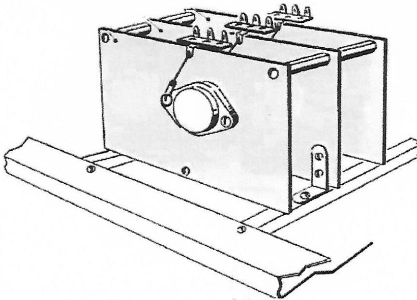
Fig 6: Montage des 3 transistors de régulations
