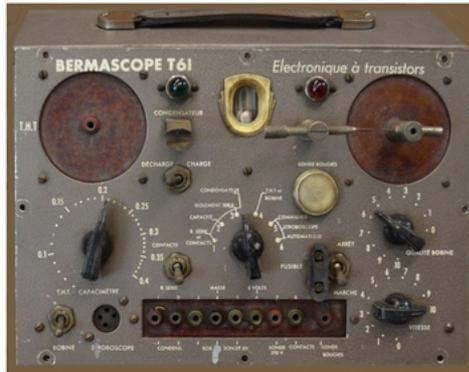
Cet appareil permettait de vérifier bobines et condensateurs, et le seul instrument de mesure, trônant au milieu, était un « œil magique » (tube à vide faisant fonction de galvanomètre rudimentaire) les « mesures » étaient données par la position du bouton d'un potentiomètre et un moteur électrique entraînait un rupteur pour donner l'étincelle dans l'éclateur.
