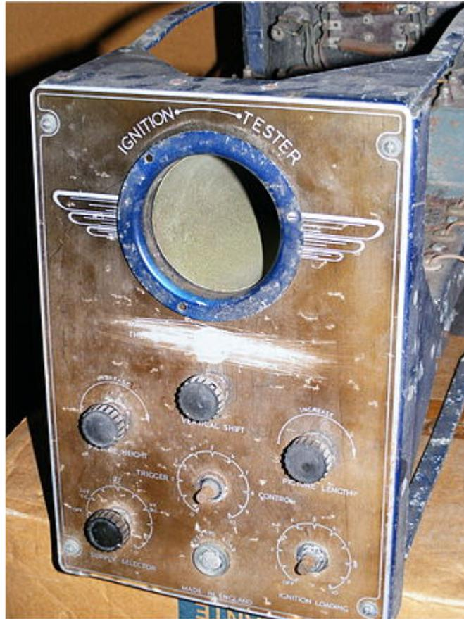
Les avions de ligne à pistons comme le DC3, avaient des oscilloscopes embarqués pour observer les allumages, du genre de l'igniscope English Electric, ci-dessus.
