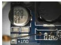
Un petit essai thermique pour s'assurer du fonctionnement fiable du LM2596 qui anime la carte permet de voir que l'aspect thermique n'est pas très favorable malgré le montage à 42 trous métallisés sous la puce, pour évacuer la chaleur par la face inférieure cuivrée.
