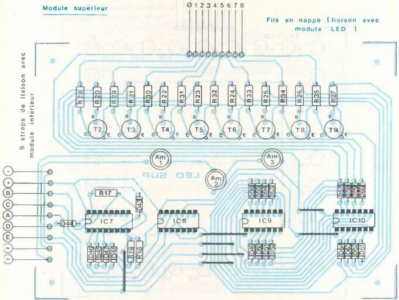
Ne pas oublier les straps et bien veiller à l'orientation du méplat des circuits intégrés.
