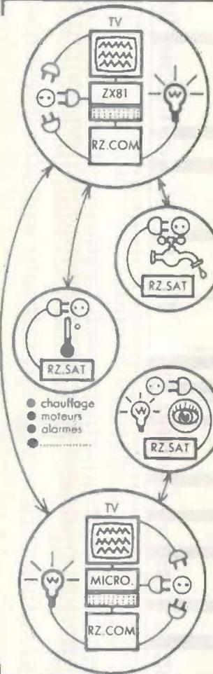
RZ.COM et ses satellites RZ.SAT associés à distance, permettent de commander des appareils électriques (lampes, radiateurs, moteurs, électrovannes, sirènes, postes radio, etc), effectuer des mesures de paramètres variés (lumière, humidité du sol, température, potentiomètre, etc) et communiquer avec d'autres ordinateurs (ZX81 ou liaison RS2 32 à 300 bauds).
