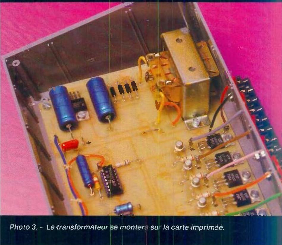
Photo 3. - Le transformateur se montera sur la carte imprimée.
