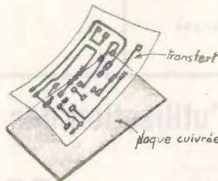
Le transfert se frotte avec un crayon tendre sur la plaque cuivrée. Dès le dessin déposé, l'ensemble se plonge dans un liquide non protégés par le transfert. On obtient alors un véritable circuit imprimé.
