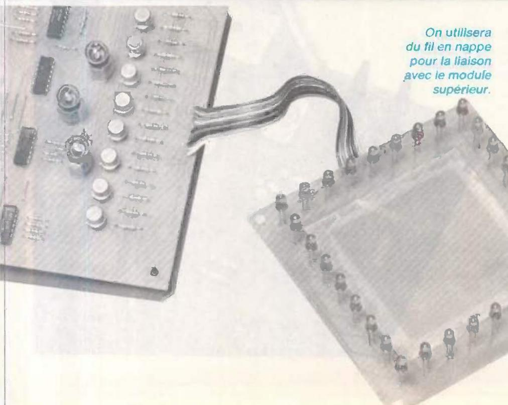
*On utilisera du fil en nappe pour la liaison avec le module supérieur.*
