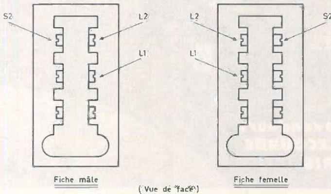
**Exemple de raccordement du montage et brochages des prises téléphoniques.**
