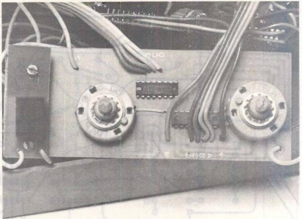
Photo 2. — Détail du circuit de programmation équipé de deux rotacteurs.
