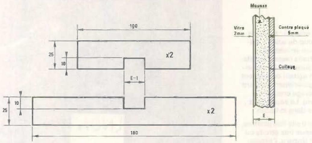
Détails de réalisation d'un châssis de pressage. Il faudra faire un travail bien d'équerre.
