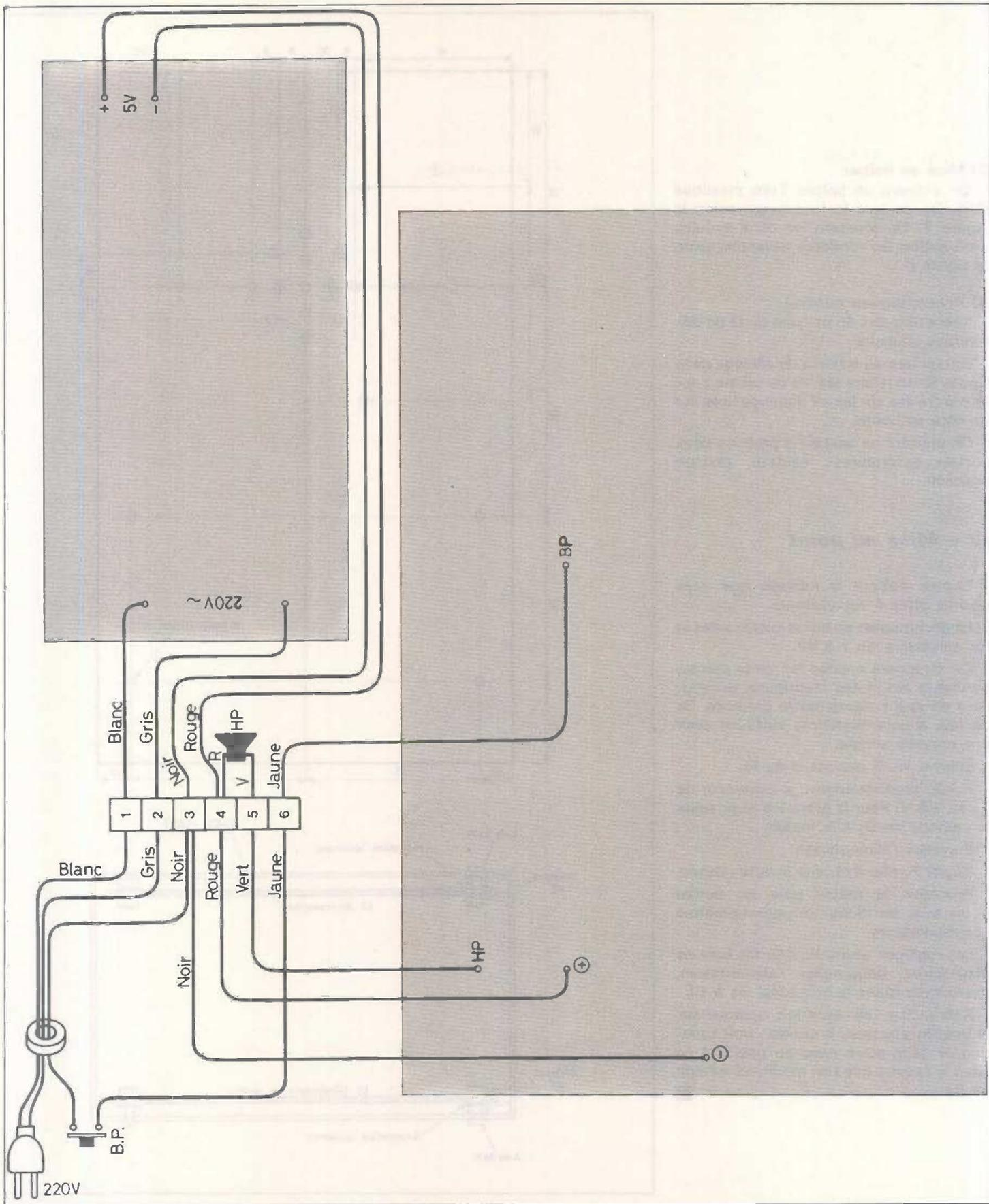
Fig. 9. - La section alimentation sera raccordée au module par l'intermédiaire d'un « domiño » en suivant le câblage donné.
