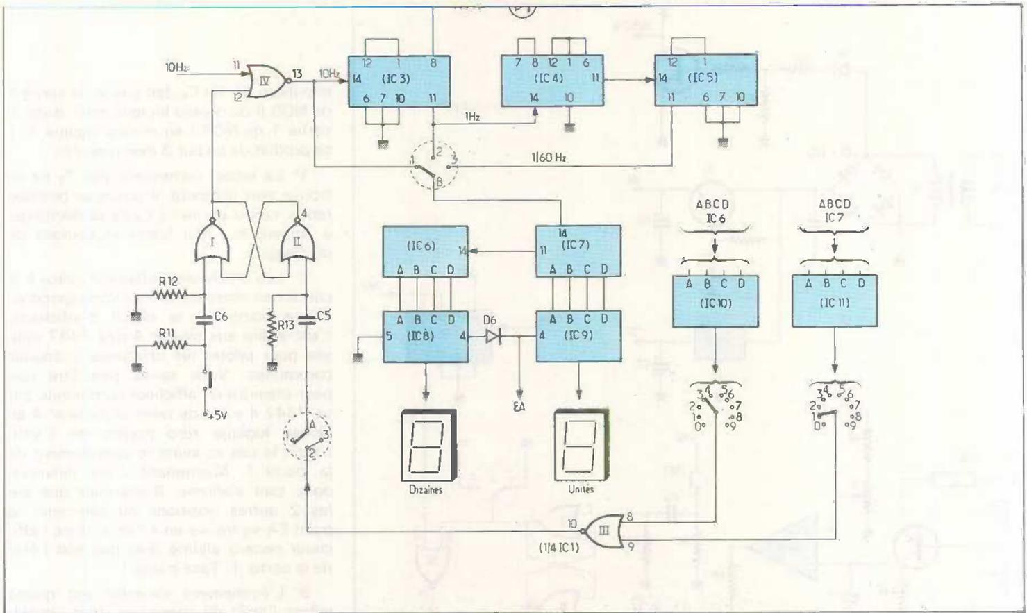
Fig. 5. — Schéma de principe du montage en compte-pose et la section affichage qui emploie deux afficheurs à anode commune.
