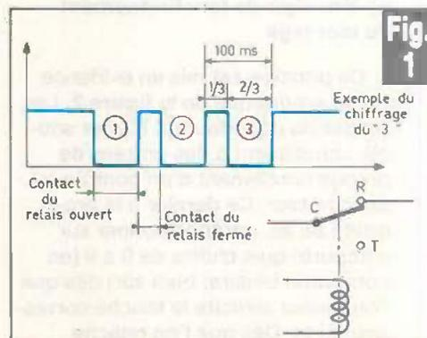
Mise en évidence du principe du chiffage téléphonique.
