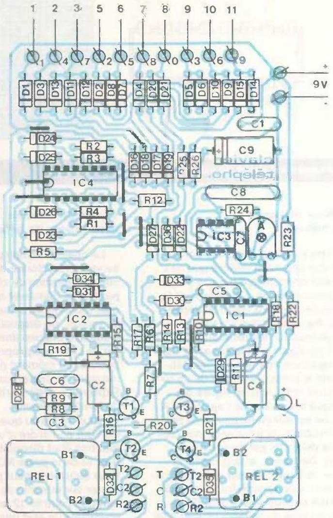
Le tracé du circuit imprimé publié grandeur nature fait l'objet d'une feuille transfert spéciale qui porte la référence : 2199100 Mécanorma. L'implantation des éléments réclamera un soin attentif.
