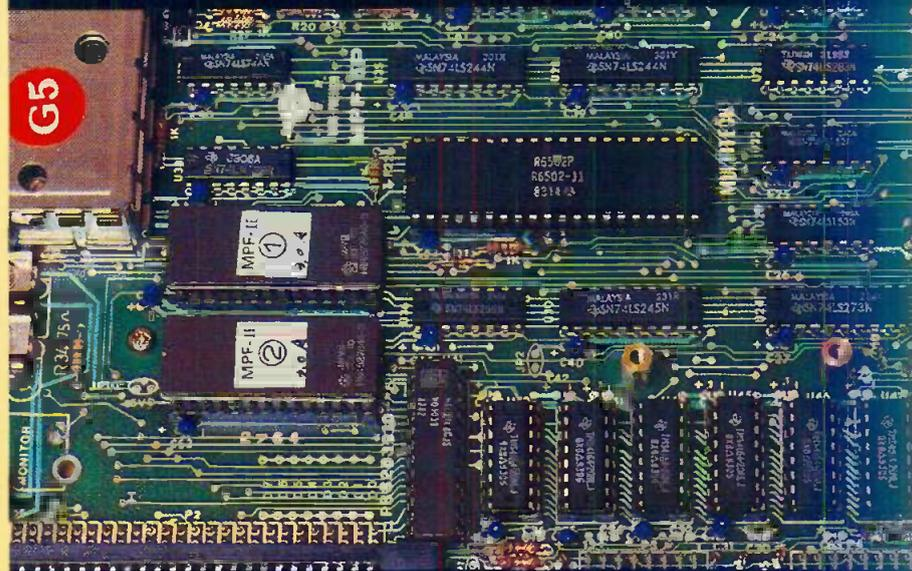
Photo 4. - Les deux Eproms contenant le Basic et le moniteur, le mille pattes à 40 broches CPU 6502 et la rangée de mémoires 4164.
