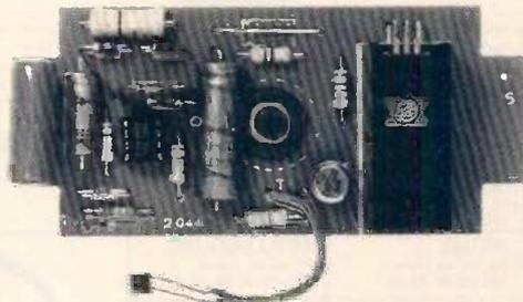
Conçu uniquement pour des charges résistives, ce thermostat possède une précision de 1/3 de degré. D'une puissance de 1500watts, il se branche en trois fils sur le secteur 220 volts.
