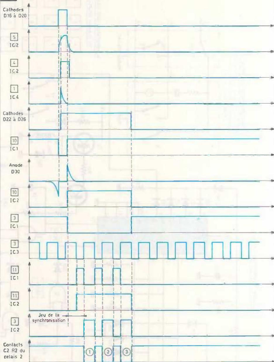
Allures caractéristiques des signaux en divers points du montage.
