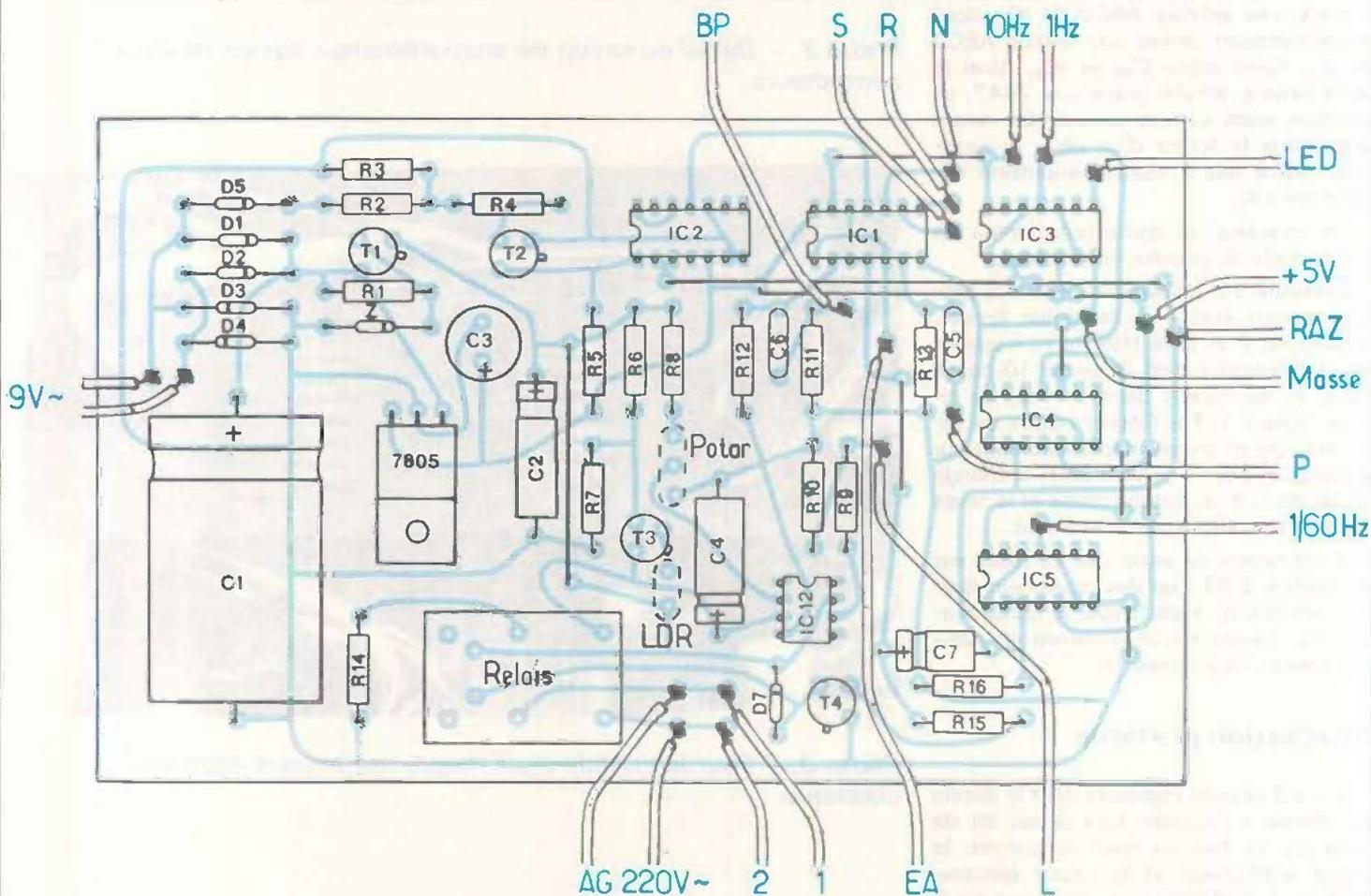
Fig. 6. à 8. — L'auteur a réalisé une carte imprimée qui se reproduira facilement par le procédé photographique ou bien les éléments de transfert direct. Les croquis sont précisés grandeur nature. Attention à la présence de nombreux straps de liaisons dont certains très longs. Tracés des circuits d'affichage et de programmation.
