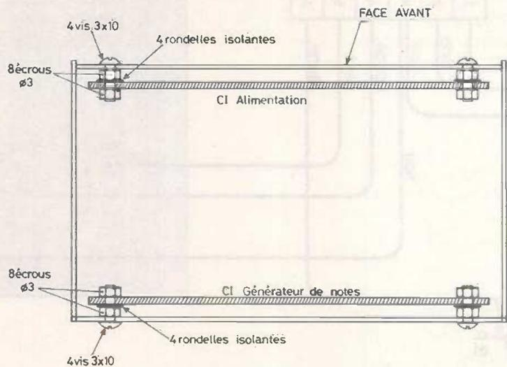
Fig. 7. et 8. - Le montage pourra par la suite très facilement s'introduire à l'intérieur d'un coffret Teko de référence P / 4. Il suffira de suivre les croquis ci-dessus.
