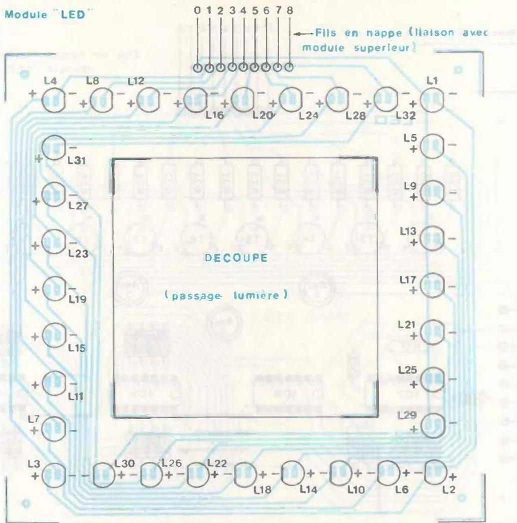
Au niveau de l'implantation des éléments, il conviendra de scrupuleusement respecter l'orientation des diodes LED.
