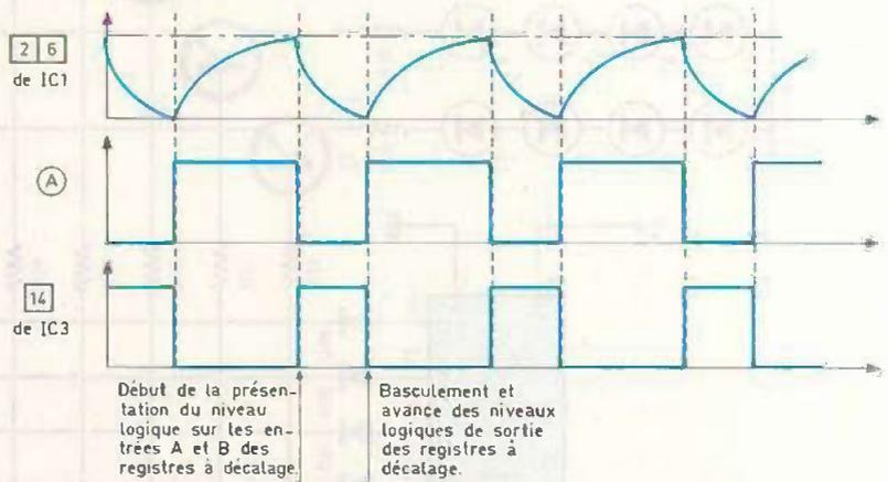
**Allures caractéristiques des signaux en divers points du montage.**
