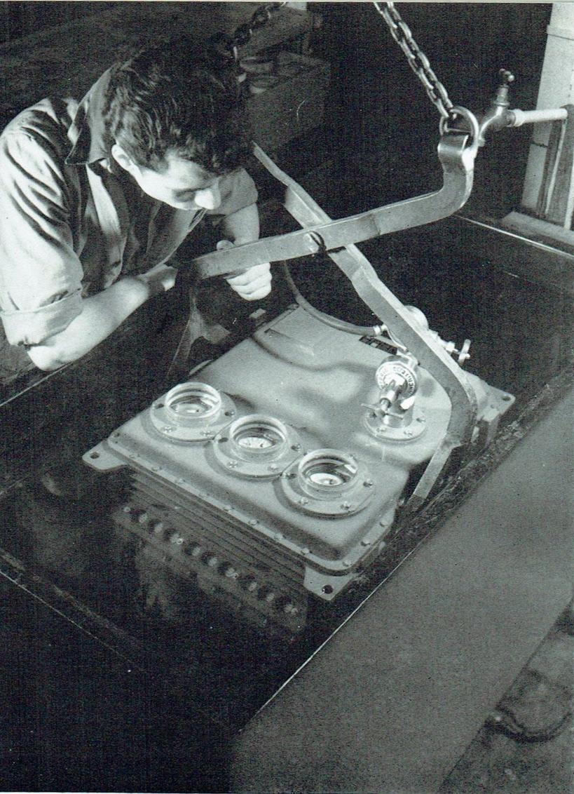
*Contrôle dans l'eau de l'étanchéité d'une cuve mise préalablement en pression. A noter l'épaisseur des hublots en plexiglas permettant l'éclairage des cadrans par la tranche, de l'extérieur — et les broches multiples étanches CICE.*
