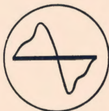
Oscillogramme sans contre-réaction.
