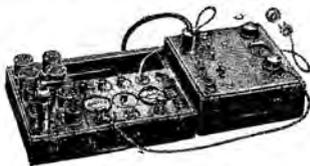
directement sur le cadran des appareils de mesure. Ce coefficient, qui dépend de la pente de la lampe et de ses autres caractéristiques, définit l'état de la lampe avec une sécurité qu'on ne peut atteindre par la mesure du courant cathodique, la lampe étant essayée dans des conditions très voisines de celles de son utilisation sur le poste.
