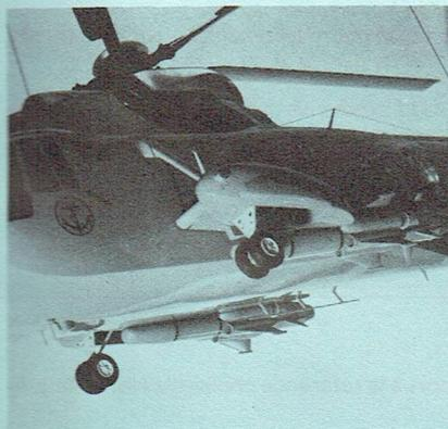
Photo C. - Montage de l'Otomat sur hélicoptère.
