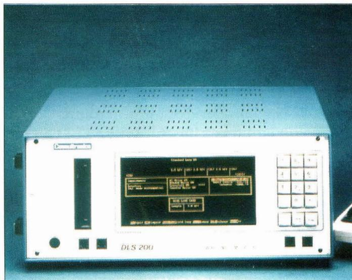
□ Le DLS 200 HE, commercialisé par la société TECHNICOME (Groupe P. BALLOFFET), est un simulateur de câble intégrant un générateur de perturbations, télécommandable par bus IEEE, il peut être intégré dans des bancs de mesure.
