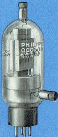
Avec ces tubes à grille-écran, on peut obtenir une amplification par étage supérieure à celle donnée par les tubes triodes analogues.
