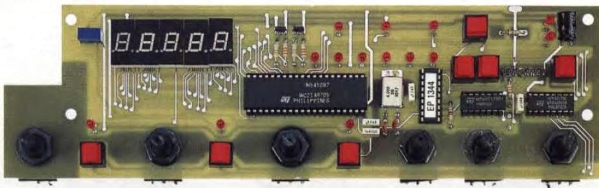
Fig.3 Foto dello stadio display siglato LX.1344 visto dal lato dei componenti. Prima di saldare i diodi led sul circuito stampato, controllate di quanto dovrete tenere lunghi i loro terminali. Le loro teste devono fuoriuscire leggermente dal pannello frontale.
