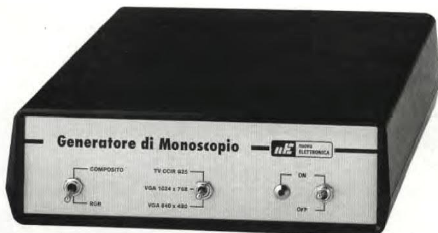
Fig.2 Come si presenta il pannello frontale del Generatore di monoscopia per televisori e monitor VGA.
