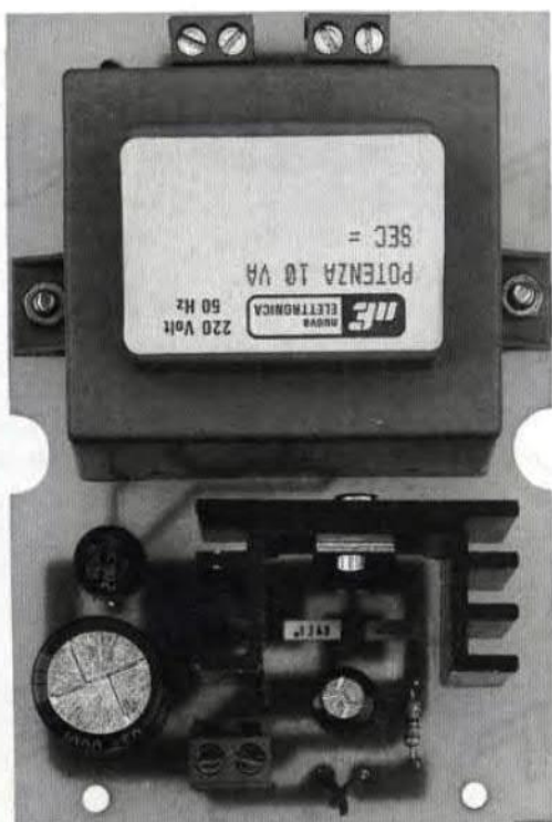
Fig.9 Qui sopra, la foto ridotta dell'alimentatore LX.1348. Questo circuito va racchiuso entro un mobile plastico (vedi fig.11), per tenere isolate le piste dello stampato percorse dalla tensione di rete dei 220 volt.
