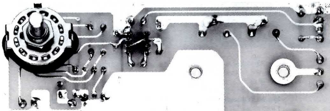
Fig.8 Lo stesso circuito visto dal lato opposto. Come spiegato nell'articolo i terminali dei commutatori andranno sagomati a punta.
