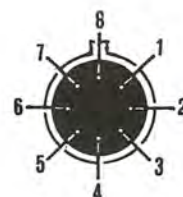
Fig. 2 Lo zoccolo dell'integrato uA.709 è provvisto di 8 terminali, disposti come vedesi in disegno. Si tenga presente che il terminale n. 8 si trova in corrispondenza della tacca di riferimento, che il terminale n. 1 è quello collocato subito sulla destra, mentre il n. 7 è quello che si trova sulla sinistra di tale tacca.
