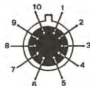
Fig. 1 Lo zoccolo dell'integrato TAA 300 è provvisto di 10 terminali. Il piedino n. 1 (visto dal di sotto) è il primo a destra prendendo come riferimento la tacca sporgente dal corpo.
