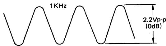
Abb. 3-12 Tonausgangssignal bei Wiedergabe
