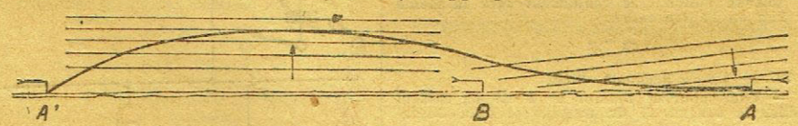
Fig. 6. — Déviation et mirage d'un rayon hertzien. — Les flèches indiquent le sens où les indices décroissent.
