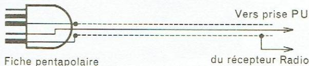
Dans le cas d'une entrée pentapolaire : utiliser un câble blindé à deux conducteurs.
