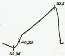
D) Injecter le signal sur la grille V 11. Le tube V 10 sera remplacé par la sonde 1003. Régler le primaire et le secondaire de LM 3 sur 34 MHz, puis régler LR 2 pour un minimum de signal sur 39,5 MHz. →
