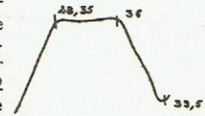
E) Appliquer le signal sur la grille de la changeuse par l'intermédiaire d'un support spécial. Remplacer V 11 par la sonde 1003. Régler LM 1 et LM 2 sur 34 MHz. Régler LR 3 pour un minimum de signal sur 41,25 MHz. →
