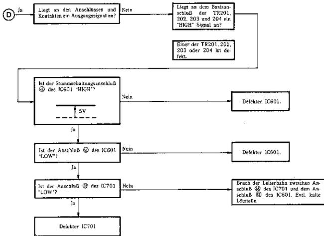
**Prüfung des digitalen Ausgangsschaltkreises**
