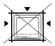
Das Gerät erwärmt sich im Betrieb. Um eine Überhitzung zu vermeiden, keine Decken auf das Gerät legen. Die Lüftungsschlitze müssen frei bleiben. Nicht in der Nähe von Heizkörpern aufstellen. Nicht ständiger direkter Sonnenbestrahlung aussetzen. Bei Aufstellung in einem Regal nach allen Seiten mindestens 5cm frei lassen.
