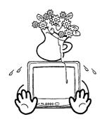
Keine Vasen oder wassergefüllte Behälter auf das Gerät stellen! Wenn Flüssigkeit ins Gerät gelangt ist, sofort den Netzstecker aus der Steckdose ziehen. Bringen Sie das Gerät in eine Fachwerkstatt, bevor Sie es weiter benutzen.
