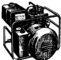
1 cylindre, 4 temps. Soupapes latérales. Refroidissement par air pulsé. Régulateur à air réglable. Démarrage par ficelle ou batterie 12 V. 2 sorties : la 1<sup>re</sup> en 110 V alt., 600 W ; la 2<sup>e</sup> en 12 V continu pour recharge de batterie. Tableau de commande avec volt-ampèremètre. Bouton de démarrage et prises de sorties. Monté sur châssis. Long. 0,40, H. 0,60, l. 0,50 m Poids : 60 kg ..... **1.000,00**
