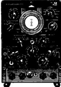
**BALAYAGE :** de 1 cycle à 1 Mcs en 7 POSITIONS RELAXE ou DECLENCHÉ AMPLI VERTICAL : Sensibilité 100 mV/cm - Bande passante 7 Mcs - Atténuateur V : 0,1 v à 1 Kv - Ligne à retard : 0,2 μ sec. Marqueur 1 et 0,1 μ sec. - Générateur : 1 Kcs, signaux carrés, 10 V crête - Post accélération : 1 500 V.
