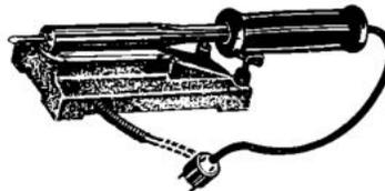
Ce support de fer à souder, à plaque chauffante incurvée maintient le fer à la même température, ce qui évite de brûler la soudure. Il convient pour des fers à souder de 40 à 300 W. Il comporte un bilame réglable suivant la puissance du fer. Dimensions : longueur 170 mm; largeur 78 mm; épaisseur 45 mm. Poids : 1,100 kg.
