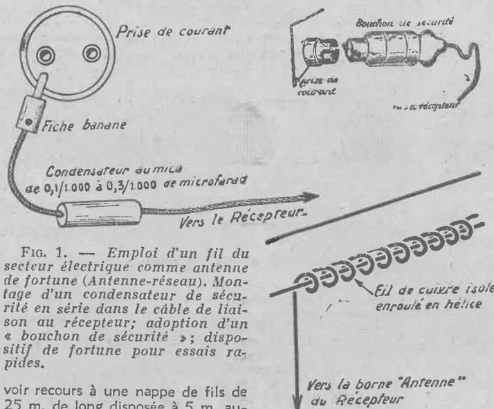
FIG. 1. — Emploi d'un fil du secteur électrique comme antenne de fortune (Antenne-réseau). Montage d'un condensateur de sécurité en série dans le câble de liaison au récepteur; adoption d'un « bouchon de sécurité »; dispositif de fortune pour essais rapides.
