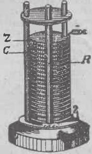
FIG. 40. — L'ancêtre des piles chimiques : la pile de Volta. — Cette pile, qui remonte à plus de 140 ans, est constituée par un empilement respectif de disques de cuivre C et de zinc Z, séparés par des rondelles de drap R imbibées d'acide sulfurique étendu. Les disques de cuivre sont les pôles positifs ; les disques de zinc, les pôles négatifs. Les dix éléments représentés sur la figure sont associés en série.
