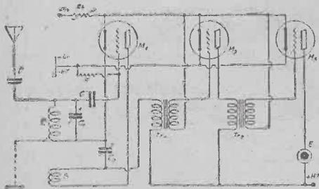
FIG. 13. — Schéma d'un amplificateur-détecteur à trois lampes.
