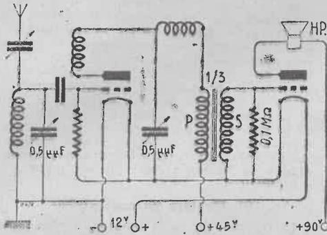
par la batterie à 12 V. d'une voiture. Si le haut-parleur est assez sensible, il peut être monté directement dans l'anode de la lampe
