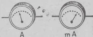
FIG. 12. — Symboles schématiques d'un ampèremètre (à gauche) et d'un milliampèremètre (à droite).
