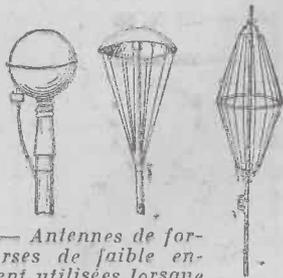
FIG. 3. — Antennes de formes diverses de faible encombrement utilisées lorsque la place est limitée. Modèles sphérique, en « parachute », en « tonneau ».
