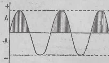
FIG. 14. — Amplitude A d'un phénomène alternatif sinusoïdal.
