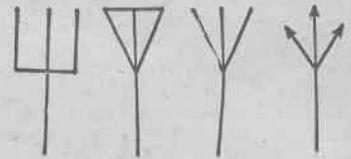
FIG. 15. — Divers symboles schématiques d'une antenne.
