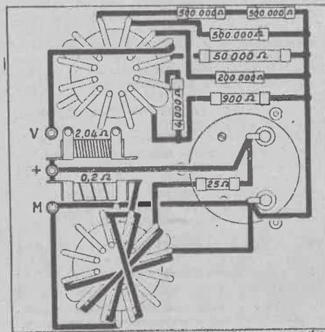
FIG. 2. - PLAN DE CABLAGE
