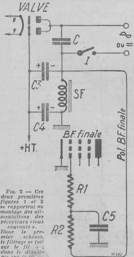
FIG. 2 — Ces deux premières figures 1 et 2 se rapportent au montage des alimentations des récepteurs « tous courants ». Dans le premier schéma, le filtrage se fait sur le fil + ; dans le deuxième sur le fil —.
