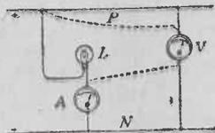
FIG. 37. — Comment l'on se sert d'un voltmètre et d'un ampèremètre. — On mesure la tension électrique d'un réseau en branchant le voltmètre V entre les deux fils P et N, positif et négatif du réseau. On peut aussi brancher le voltmètre entre les deux points « p » et « n » où aboutissent les connexions de la lampe L, lampe d'éclairage ; A, ampèremètre branché sur la connexion de la lampe pour mesurer l'intensité du courant qui passe dans cette lampe.
