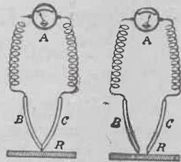
FIG. 38. — Deux aspects d'un couple thermoélectrique. — A, ampèremètre ; B, C, éléments du couple, formé de deux lames de métaux, l'un électropositif, l'autre électro-négatif soudés sur une résistance chauffante R. A gauche, les deux éléments sont soudés entre eux et ne reposent que par un point sur la résistance ; disposition médiocre. A droite, les deux éléments sont soudés séparément sur la chauffelette ; disposition meilleure.
