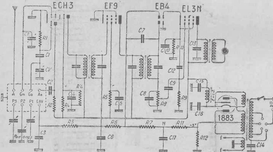
des gammes PO et de la gamme GO, les paddings  $P_1$ ,  $P_2$  et  $P_3$ . On utilisera de préférence des ajustables ayant comme capacité maximum : 500  $\mu\text{F}$  pour la gamme  $PO_1$ , 250  $\mu\text{F}$  pour la gamme  $PO_2$ , et 100  $\mu\text{F}$  pour la gamme GO. D'autre part, le fil commun des bobinages de réaction sera relié au fil de masse.
