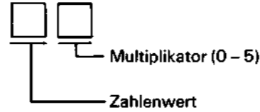
Abb. 4 Code für leitungslose Widerstände
