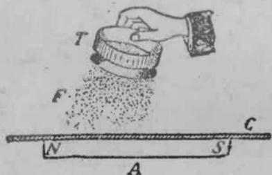
FIG. 20. — Comment obtenir le spectre magnétique d'un aimant. — A, barreau aimanté; N, S, pôles nord et sud; C, feuille de carton placée horizontalement sur le barreau; T, tamis à mailles fines servant à répartir uniformément sur le carton de la limaille de fer F, formant le spectre.
