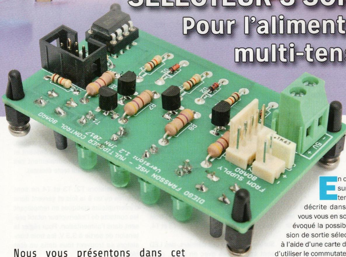
Nous vous présentons dans cet article une interface pour l'alimentation multi-tension décrite dans le numéro 148. Il s'agit d'un sélecteur qui permet de régler la tension de sortie à l'aide de boutons. L'utilisation d'un microcontrôleur de type Atmel sera l'occasion d'une étude approfondie de l'ATTiny.
