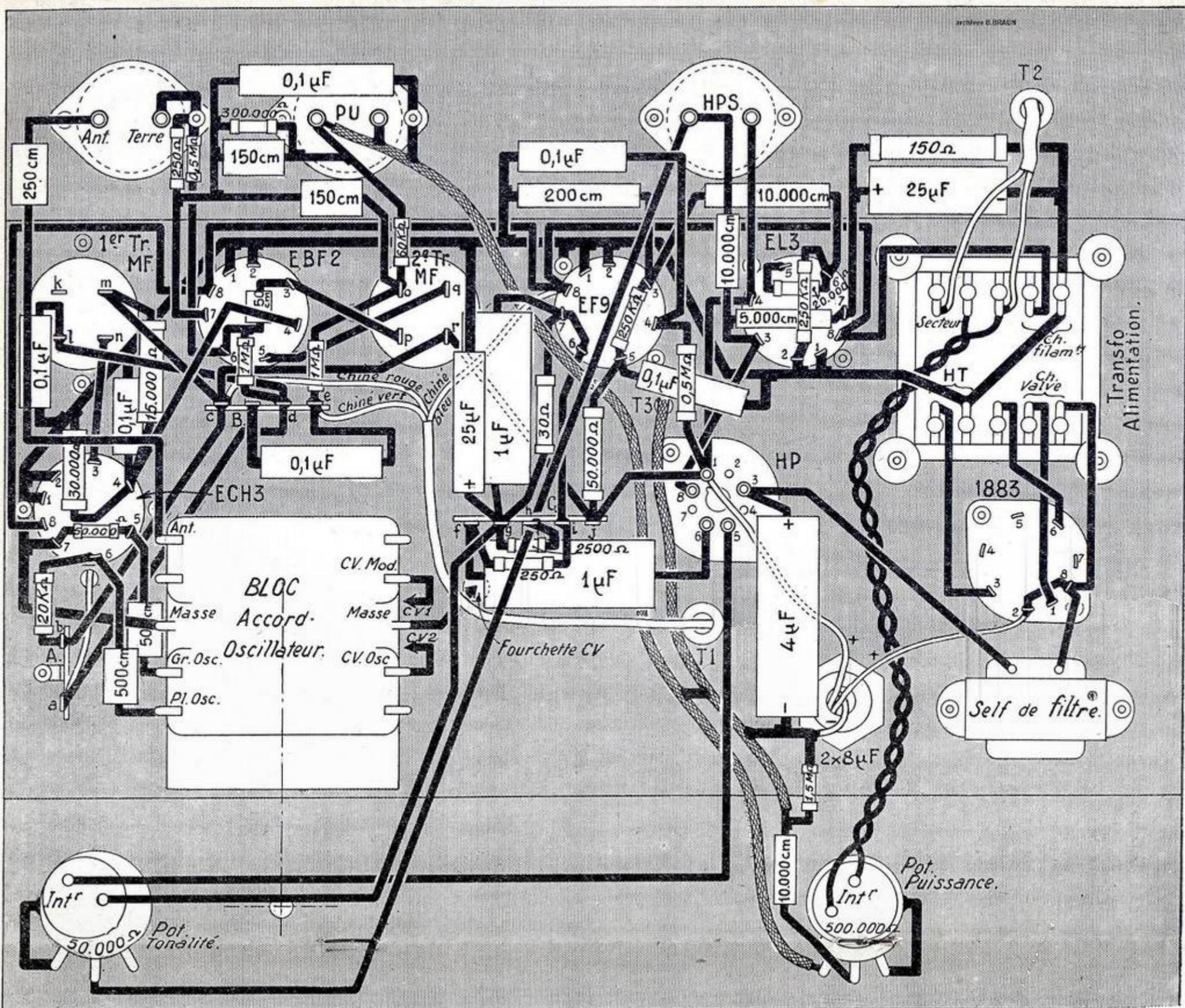
viendra s'adapter sur la corne de la ECH3. L'autre fil de la résistance de 1 mégohm est relié par une connexion à la cosse *a* du relais A. Sur la cosse du bloc repérée CV osc. on soude une connexion venant de la cosse inférieure du condensateur variable relative à la cage de cet organe la plus proche du cadran.
