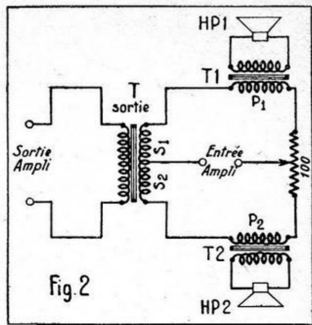
il en résultera des courants égaux dans les deux transformateurs, et les deux haut-parleurs se trouveront en même temps actionnés. Malgré cela aucun courant ne circulera dans la diagonale, à condition toutefois que le pont soit parfaitement équilibré. C'est pour obtenir très exactement cet équilibre, de façon à éviter tout accrochage, que le potentiomètre  $P_1$ , à variation linéaire est prévu. Le réglage en est assez délicat.
