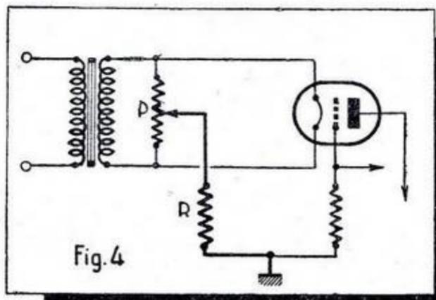
avec une pentode EL3 dont le courant d'anode est de 36 mA et le courant d'écran de 4 mA, il faudrait une résistance de  $6/0,040 = 150$  ohms.
