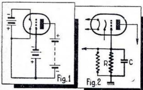
faire travailler les lampes à un point de fonctionnement situé dans une portion convenable de la caractéristique.
