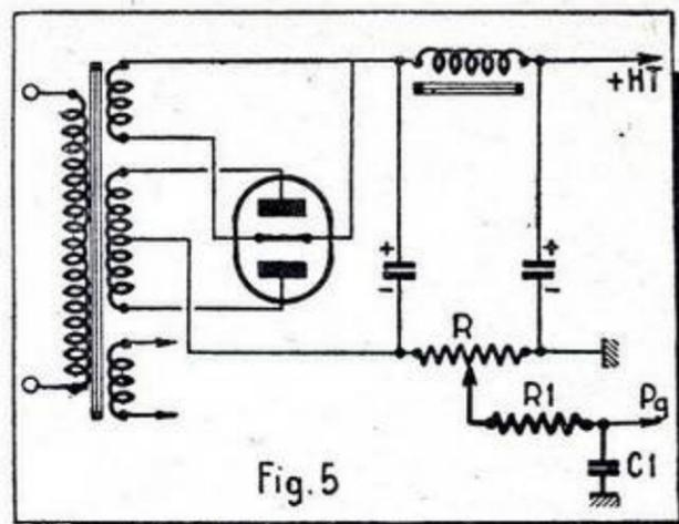
sont du type électrolytique sec, permettant d'obtenir sous un faible volume une capacité importante à faible isolement ; un fort isolement n'étant pas nécessaire car ils ne sont soumis qu'à de basses tensions.
