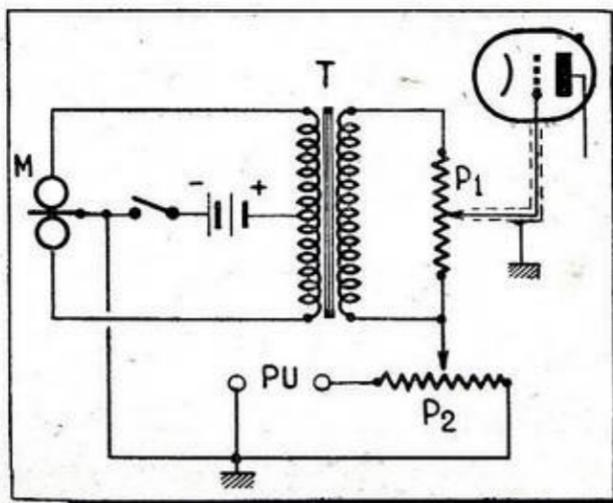
se trouve pratiquement en parallèle avec la diode, celle-ci ne peut ainsi assurer la détection des signaux. Il n'existe donc aucun risque que les émissions viennent se superposer et gêner les auditions phonographiques. Par ailleurs, le pick-up peut supporter la charge résultant de la diode sans que la tension qu'il fournit en soit sensiblement affectée.
