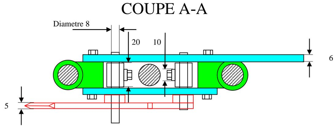
VIS MERE : DIAMETRE SUR FILETS 19 mm.. PAS: 10 TOURS AVANCENT DE 7,5 mm SOIT UN PAS DE 0,75 mm. FILET TRIANGULAIRE
