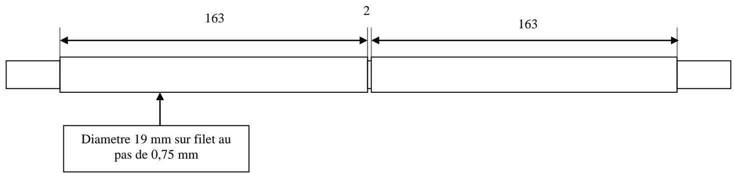
Penser a bien verifier de quel cote se situe le pas a gauche et le pas a droite de la vis mere cela en fonction du sens de rotation de votre machine car votre systeme d'entrainement ne semble pas identique a la mienne.
