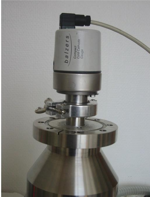
Pour confirmation...en plaçant la jauge directement en sortie de pompe, on obtient un vide de  $4,73 \cdot 10^{-6}$  torr après 15 minutes,  $2,66 \cdot 10^{-6}$  torr à 30 minutes.
