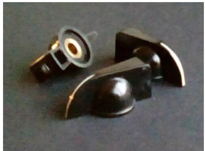
les milliers de pièces, produites par six empreintes, pour manœuvrer les commutateurs des lampemètres Metrix 310, U61.....petit détail, la vis de fixation du type 'cratère', qui combine la pointe destinée à l'axe rond d'un potentiomètre, avec le méplat adapté à celui d'un commutateur
