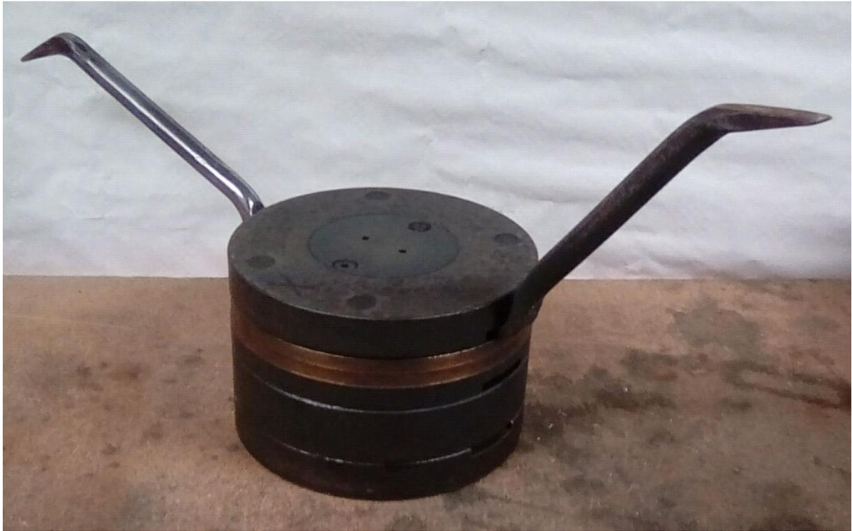
Une fois les divers éléments séparés au moyen de *pincés de moule*, introduites dans les encoches entre plaques, on note la présence de ‘doigts’ métalliques, les *goujons*, assurant le positionnement précis des diverses plaques.
