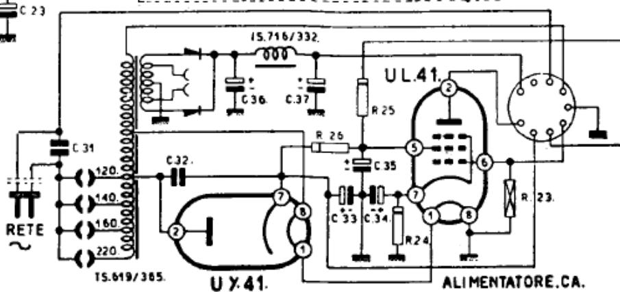
PHONOLA (S. A. FIMI) - Mod. 425. Apparecchio portatile, alimentabile anche con rete-luce a corrente alternata. Onde medie e onde corte divise in due semigamme. MF a 470 kc/s. Anodica 90 V, schermo 55 V, accensione 1,5 V. Potenza 0,23 W con pile; 1,1 W con rete-luce. Consumo 20 watt.
