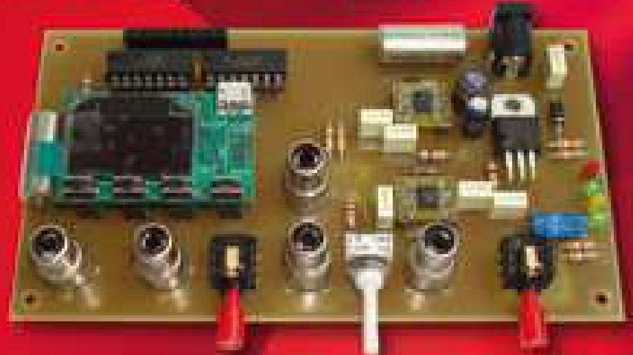
MINI OSCILLOSCOPE avec le XPROTOLAB
