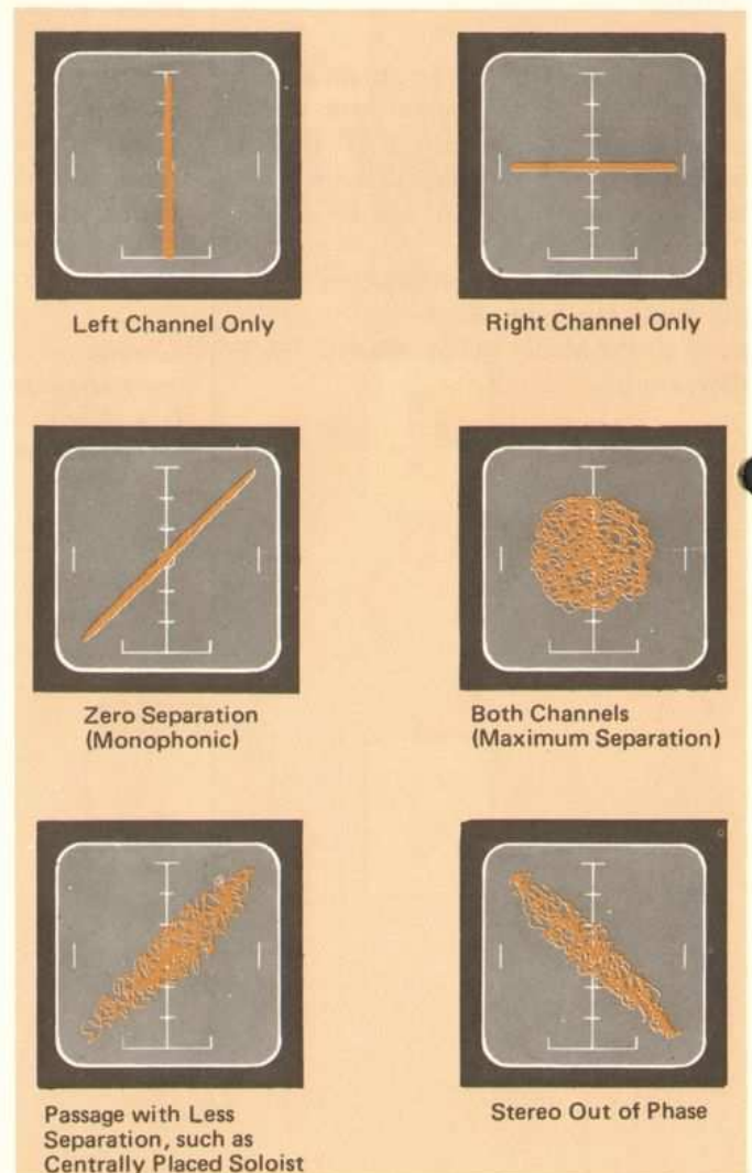
Figure 11. Audio Display Figure 11. Visualisation des signaux gauche et droit sur l'oscilloscope Abbildung 11. Anzeige eines Nf-Signals
